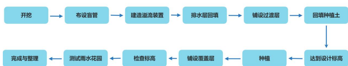
图 4.2-3 雨水花园施工步骤
