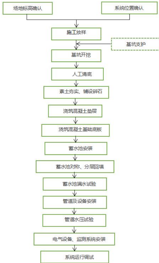
图 4.3-15 施工工序流程图
