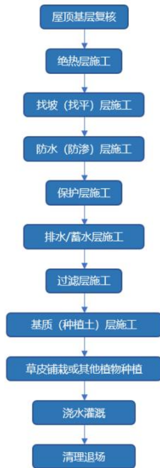
图 4.1-11 绿色屋顶施工流程图
